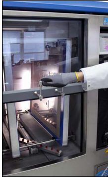
Air lock door
