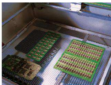
焊接区工艺室内部 (有PCB和载具)
