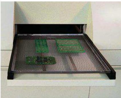
通用载具可以放置不同的电路板
