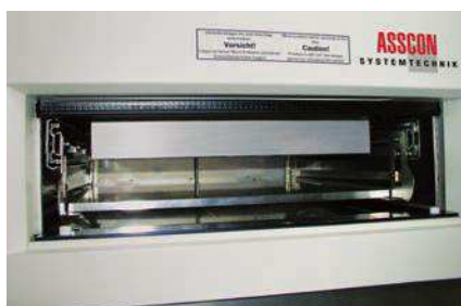
卸载锁及抽真空装置
